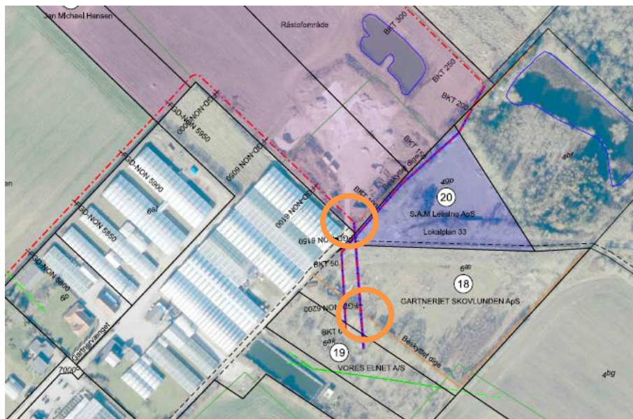
Kortbilag 4: Udklip fra ansøgningsmateriale. Oversigt over ansøgte krydsninger af beskyttede sten- og jorddiger, med styret underboring i ledning stationering FGD-NON 6125 og FGD-NON 6200, markeret med orange cirkler.
